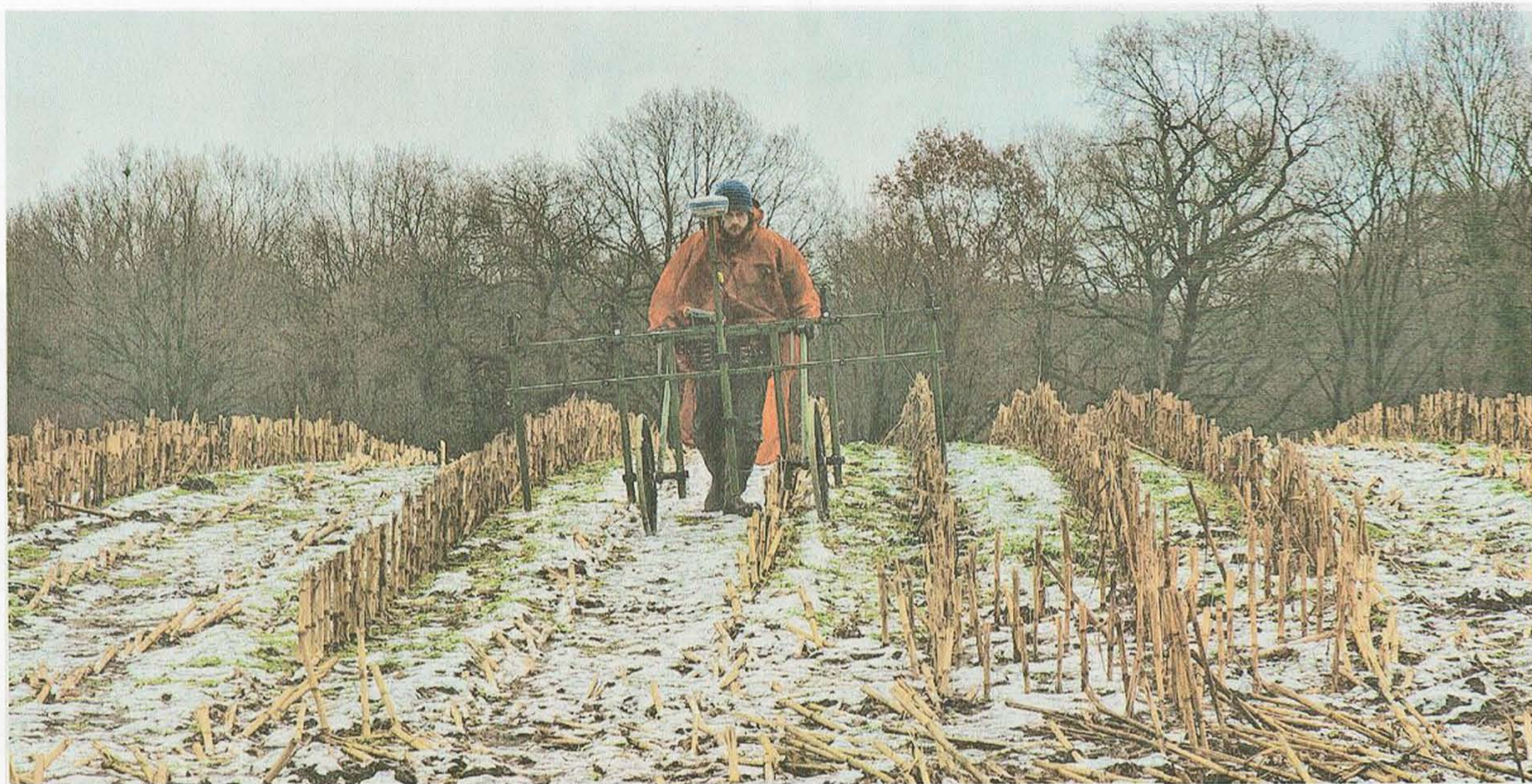
Karl-Johann Offermann vom Niedersächsischen Institut für Historische Küstenforschung schiebt das Geomagnetgerät über die Binnendüne.
