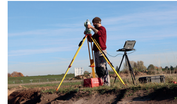
Vermessungsarbeiten am Tachymeter
