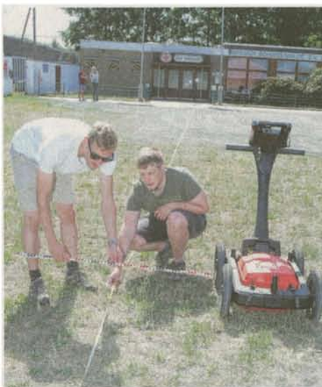
Fabian Käsbohrer links und Timo Knocks untersuchen das Areal mit dem Georadar.
